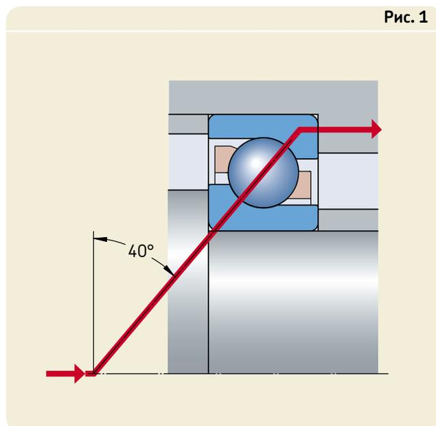
однако каждый подшипник воспринимает их только в одном направлении. Установка по O-образной схеме обеспечивает сравнительно большую жесткость подшипникового узла, благодаря чему он может также воспринимать опрокидывающие моменты.
