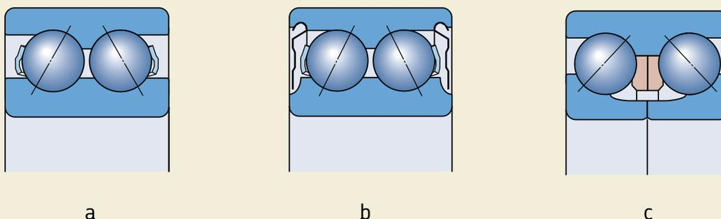
Подшипники имеют угол контакта  $30^\circ$  и комплекты шариков, установленных по O-образной схеме.
