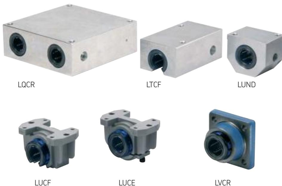
**Подшипниковые узлы для линейного перемещения LUCE/LUCS** конструктивно похожи на узлы LUCD/LUCR, но вместо закрытого корпуса эти узлы имеют открытый корпус с регулировочным винтом. Эти узлы, как правило, используются для систем, требующих нулевой зазор или преднатяг.
