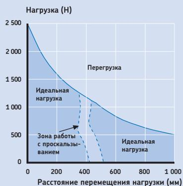
Диаграмма смещенной нагрузки – ход 200 мм
