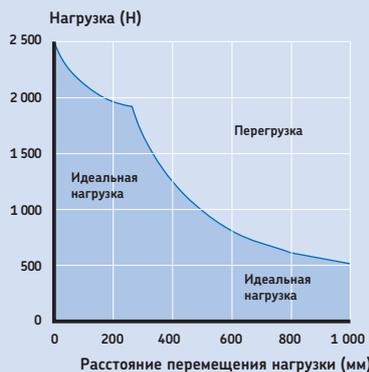
Диаграмма смещенной нагрузки – ход 500 мм
