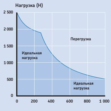
Диаграмма смещенной нагрузки – ход 600 мм
