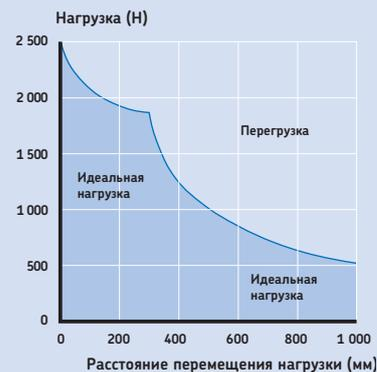
Диаграмма смещенной нагрузки – ход 700 мм
