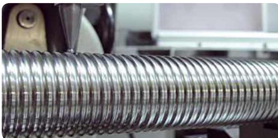
Измерение точности шага резьбы
